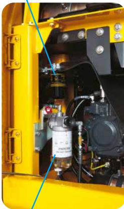
Prefiltro de combustible (con separador de agua).
