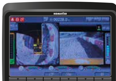
Con el sistema KomVision, sistema de cámaras trasera y laterales con vista de 360°.
