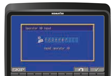
Función de identificación del operador.
