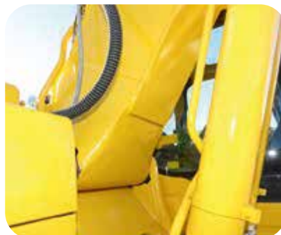
Placas superiores e inferiores de una única pieza, base de la pluma fundido.
