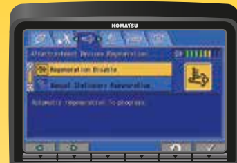
Pantalla de regeneración del dispositivo de emisiones para KDPF.
