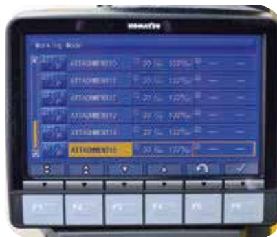
Komatsu Integrated Attachment Control (KIAC) para hasta 15 configuraciones de implementos para ajustar el caudal aceite y presión.
