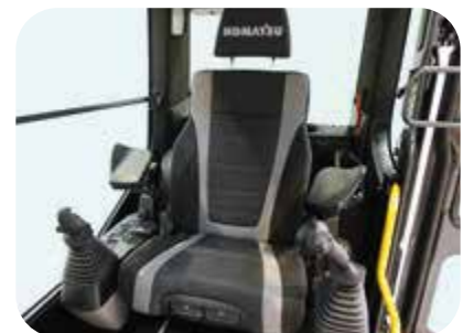
Asiento Premium opcional con tapicería de alta calidad, ajuste automático del peso, soporte para las lumbares, climatizador, disponible con reposabrazos multi-posición opcional y joysticks ergonómicos.
