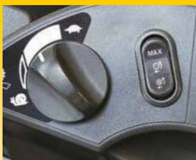
Control de desplazamiento variable con nuevo rango de velocidad de avance mínimo (izquierda) y interruptor del sistema de control de tracción (derecha).
