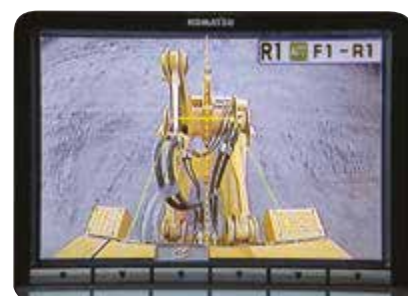
Sistema integrado de cámara para visibilidad trasera.
