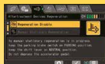
Pantalla de regeneración del dispositivo de emisiones para KDPF.
