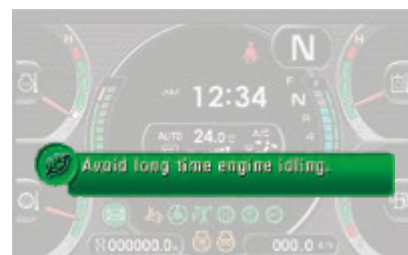
La guía de eficacia apoya el ahorro de energía en tiempo real (p. ej. evitar periodos largos en ralentí).
