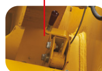
Palanca de corte de combustible
