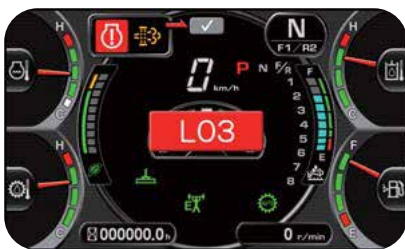
La foto corresponde a un equipo con Tier 4 final. (El medidor de nivel de DEF es solo para equipos con Tier 4 final)
