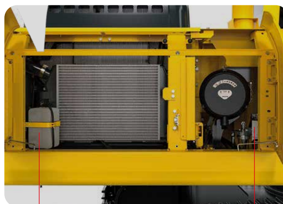
Estanque de reserva
