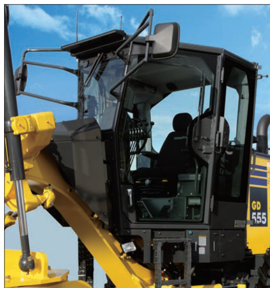
Cabina con ROPS (Estructura de Protección contra Vuelcos) (Equipada con desempañador y limpia parabrisas intermitentes)
