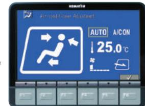
mantiene el interior de la cabina cómodo desde la parte superior a la inferior en todas las épocas del año. La función de desescarchador mantiene el vidrio de la cabina limpio.
