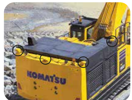
Anclajes para los arneses de seguridad
