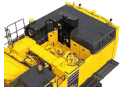
Amplia pasarela de mantenimiento central
