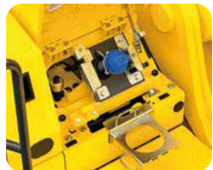
El depósito de AdBlue® está instalado en la escalera delantera. El banco incluido facilita aún más el repostado de AdBlue®.
