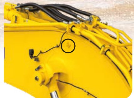
Anclajes para los arneses de seguridad
