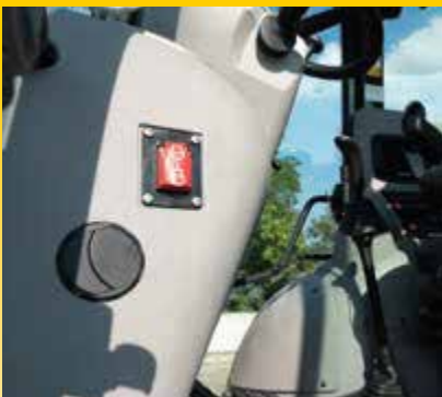
Interruptor de parada de emergencia del motor.
