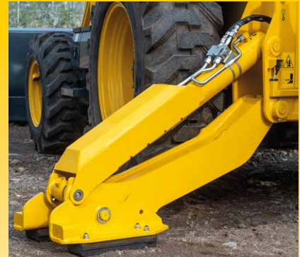
Válvulas de seguridad para los estabilizadores, la pluma y el balancín (de serie).
