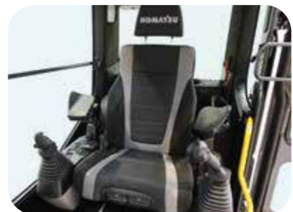
Asiento Premium opcional con tapicería de alta calidad, ajuste automático del peso, soporte para las lumbares, climatizador, disponible con reposabrazos multi-posición opcional y joysticks ergonómicos.
