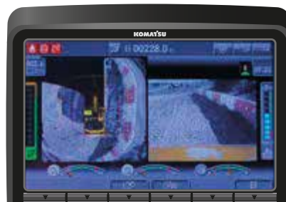
Con el sistema KomVision, sistema de cámaras trasera y laterales con vista 360°.
