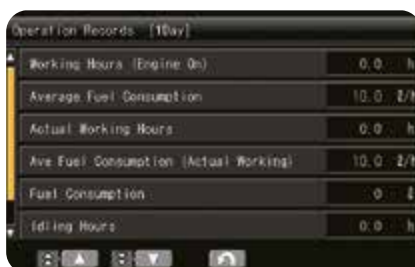
El monitor multifunción muestra y controla mucha información operativa y de mantenimiento.
