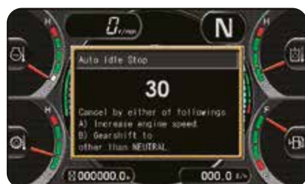
Apagado automático en exceso de ralentí.
