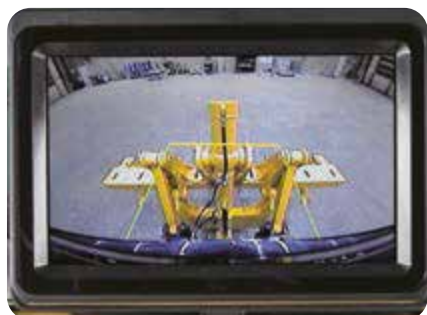
Sistema integrado de cámara para visibilidad trasera.
