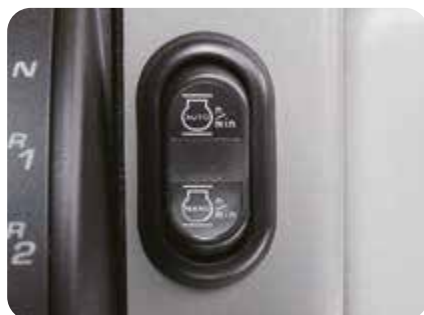
El control de revoluciones eléctrico permite al operario ajustar perfectamente las revoluciones del motor a las condiciones de trabajo.
