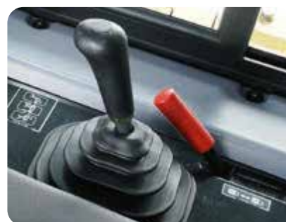
Palancas remotas de bloqueo de seguridad
