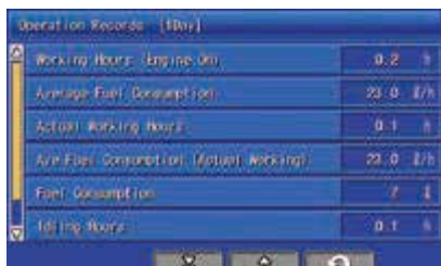
Visualización rápida de los registros de funcionamiento
