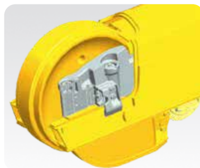
Apoyo de la rueda guía auto ajustable
