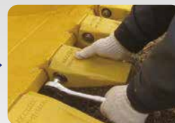
Coloque el buje, la arandela y el perno, luego apriete con la llave de trinquete.
