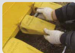
Inserte el pasador exclusivo en el orificio del pasador del adaptador.
