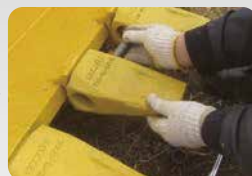
Inserte el pasador exclusivo en el orificio del pasador del portadiente.
