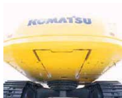
Cubierta inferior reforzada del bastidor giratorio
