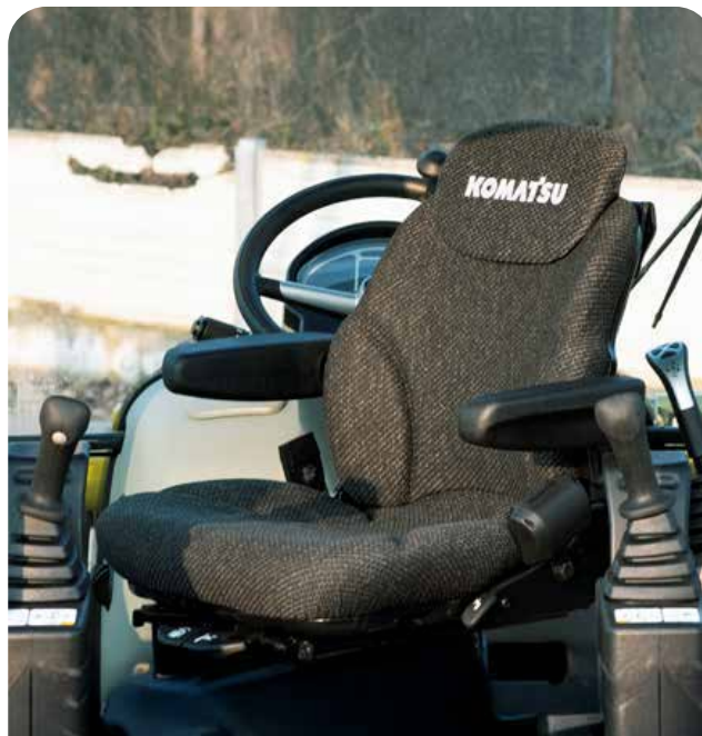
Joystick PPC para operación del brazo excavador con asiento con suspensión de aire
