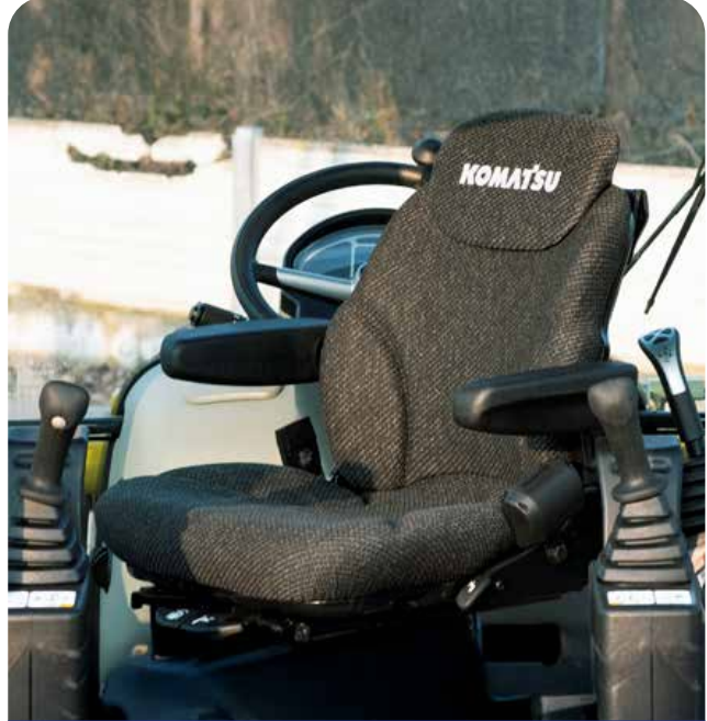
Joystick PPC para operación del brazo excavador y asiento con suspensión de aire
