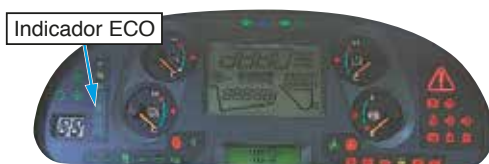
El indicador ECO ayuda al operador a ahorrar energía.
