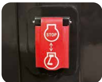
Interruptor de parada de emergencia del motor
