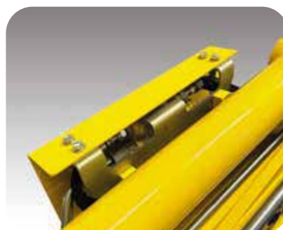
Válvulas de seguridad anticaída en la pluma y el balancín
